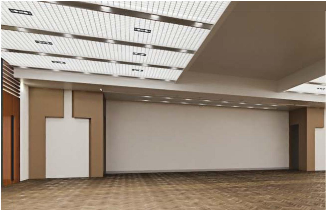
Грильято ZSP 10 представляет собой потолок в виде решетки с шириной профиля 10 мм. Данний вид потолка является самым распространенным видом грильято. Толщина оцинкованной стали 0,3 и 0,4 мм. Высота профиля 30, 35 и 40 мм.
